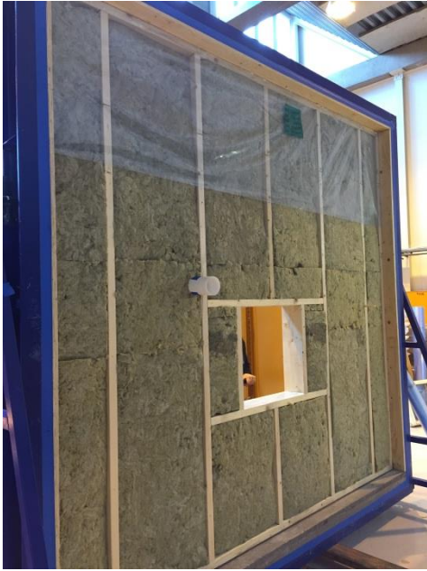
Provuppställningen sedd från insidan före montage av läkt som ersätter regler för ett installationsskikt, endast en del av lufttätthetssystemet är monterat.
